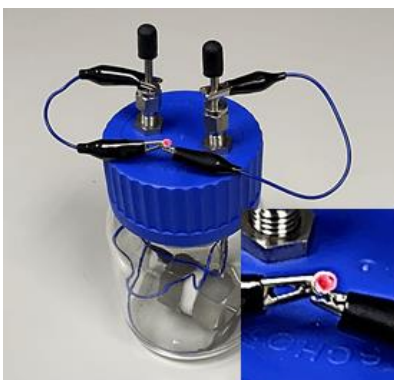
圖 1: 所發展之全固態鈉二氧化碳電池可點亮紅色發光二極體。
